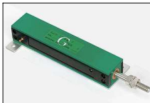
LP-50F Wegsensor zur Erfassung z.B. von Längenänderungen Gesamtlänge: L= 129 mm Messbare Dehnung bis 50 mm
