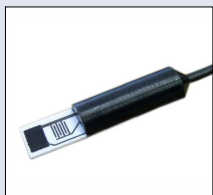
SHS - Spezialfühler zur Messung einsetzender Betauung. Kondensationssensor liefert Signal 1, wenn Benetzung mit Wasser in Folge von Kondensation auftritt. Abmessungen: 60 x 10 mm Einsatz 0...50°C
