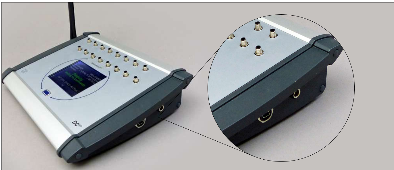
DCXP-16-R-GPRS mit integriertem Funk-Modem
